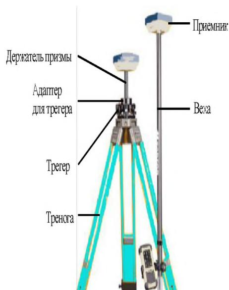
Рис. 15: Оборудование и конфигурация
