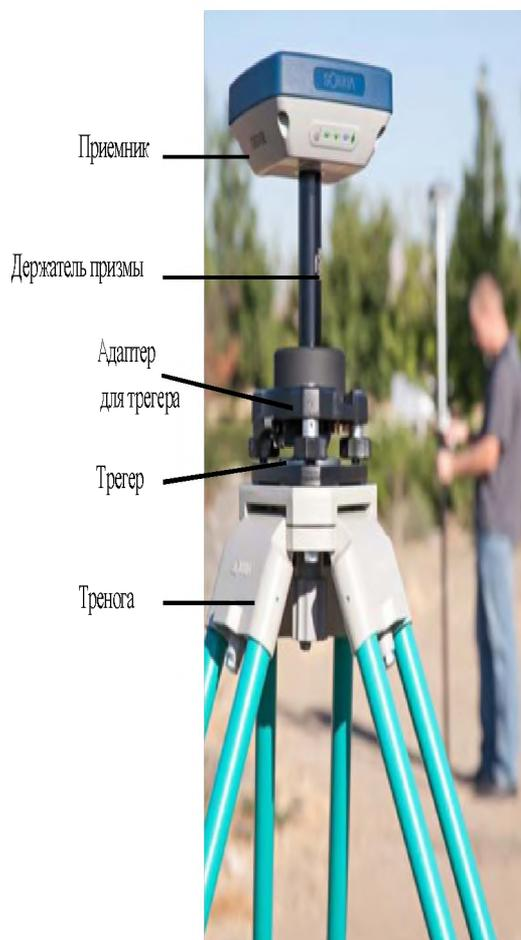
Рис. 16: Базовий приймник
