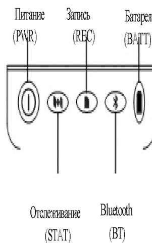
Рис. 5: Светодиодная индикаторная панель
