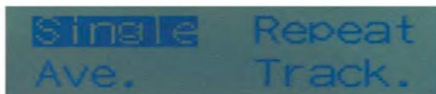
Имеется четыре режима измерений: Single-Fine (Точный однократный), Repeat-Fine (Точный многократный), Average (С усреднением) и Tracking (Слежение).
